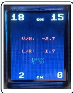
Im Display werden in den **Ecken** wird die **radspezifische Keilhöhen in cm** aufgeführt.
